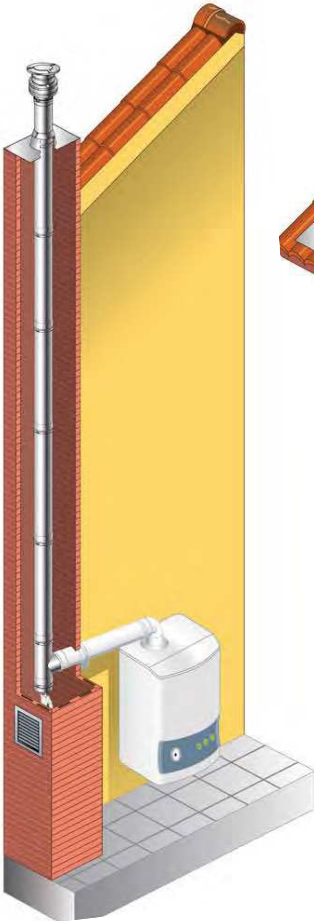
SISTEMA AN TWIN CONDENSING IN VANO TECNICO
