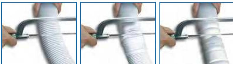
Dopo aver tagliato il tubo flessibile, per collegarsi al rigido PPs, utilizzare una guarnizione apposita (che va inserita all'interno dell'onda del flessibile tagliato), un tubo da 0,25 m (che va inserito nel flessibile) e da una fascetta di sicurezza (che stringerà gli elementi).
