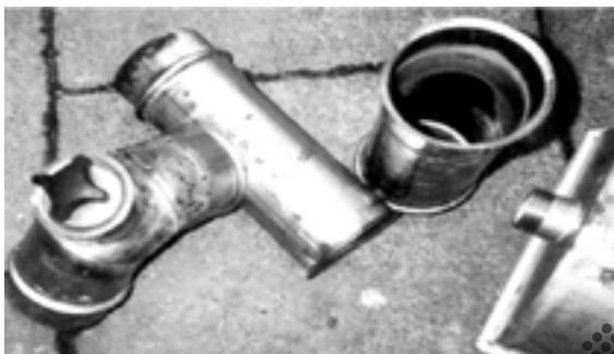
Illustrazione 26: Effetto della condensa su condotti in acciaio inox lavorati con attrezzature non idonee (calandre e stampi in acciaio al carbonio)
